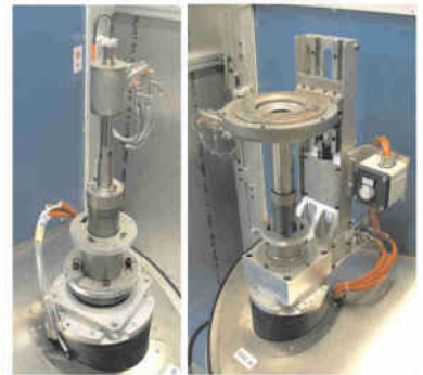
Esempio attrezzaggio mandrini Arbor retooling example
